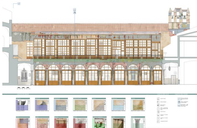
Palermo, Complesso monumentale del monastero di Santa Caterina d'Alessandria, particolare del prospetto nord del chiostro principale con l'analisi dello stato di conservazione (caratterizzazione dei materiali costituenti)
