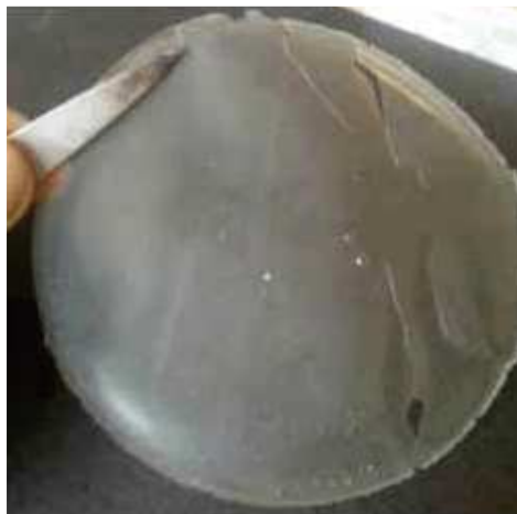
Bioplastica ottenuta combinando nanotubi di allosite e biopolimeri estratti da agrumi
