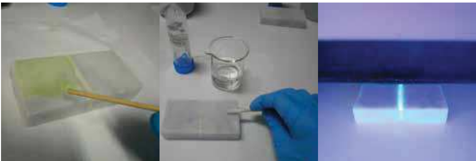
Stesura, rimozione e verifica dei residui di un sistema pulente supportato applicato su una superficie lapidea.
